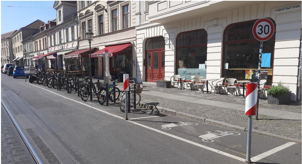
Abbildung 91: Radabstellanlage auf der Fahrbahn und Stellplätze für Lastenräder
